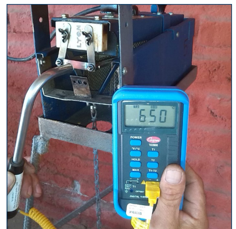
Пирометр показывает соответствующую температуру - 650°C.
