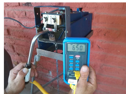
使用超高温计来测量刀片温度，需达到650°C左右
