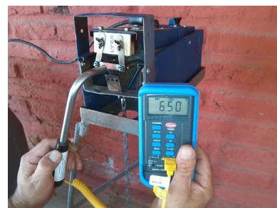
Пирометр показывает соответствующую температуру - 650°C.
