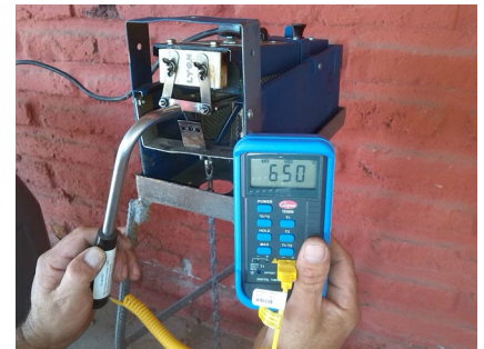
Nhiệt kế chỉ ra nhiệt độ lưỡi dao thích hợp 650°C.
