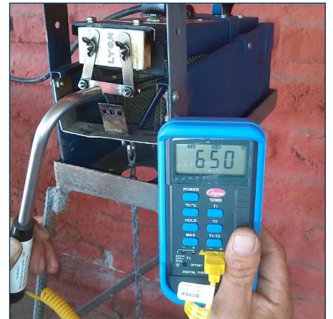
高温计显示刀片温度为650°C。
