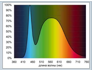
Рис. 11 Спектр холодной ( 5000К) светодиодной лампы
