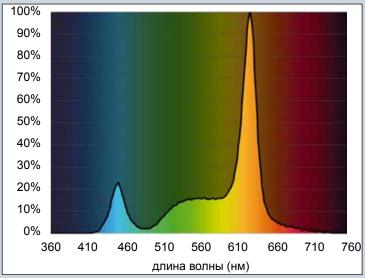
Puc. 13 Полный спектр светодиодной лампы с выделением красного спектра
