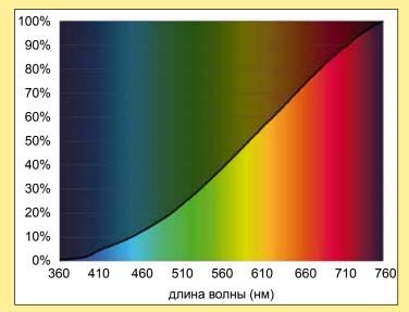
Рис. 8 Спектр лампы накаливания
