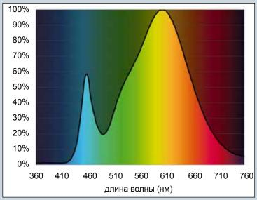
Рис. 12 Спектр теплой ( 2700К) светодиодной лампы
