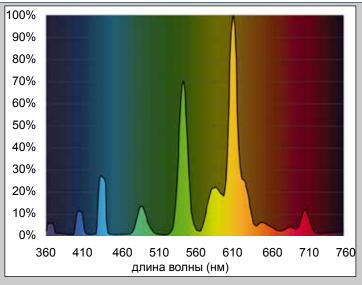
Рис. 9 Спектр теплой (2700К) флуоресцентной лампы
