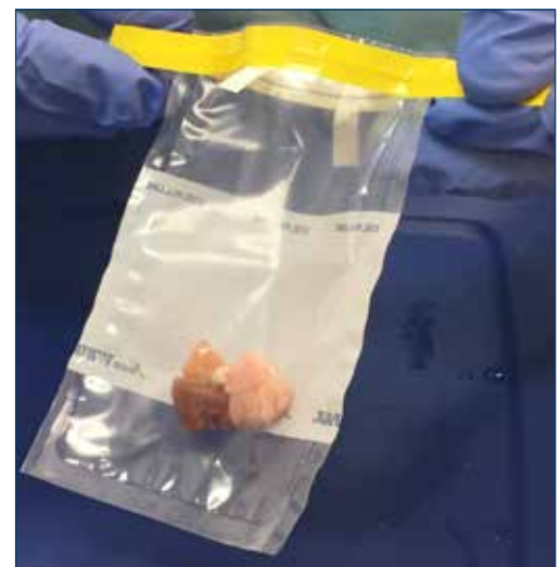
Figura 17. Las bolsas tipo Whirl-Pak® pueden sellarse, son resistentes a las fugas, y pueden utilizarse para almacenar y transportar muestras.
