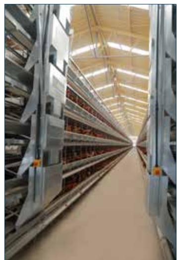
图9. 行车式喂料器，将饲料直接落入料槽中。图片由Alaso提供
