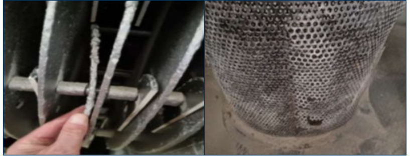
Şekil 2a,b: Aşırı aşınmış bıçaklar ve delinmiş elek.
