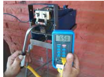
使用超高温度计来测量刀片温度，需达到650°C左右
