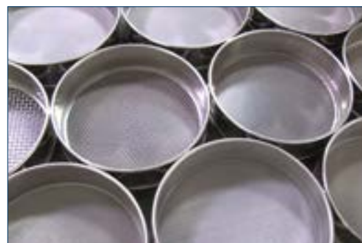
Рис. 3. Сита различного диаметра для разделения частиц разного размера. Фото предоставлено Gilson Company, Inc.
