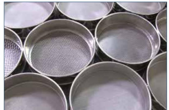
图3. 不同大小的筛，以区分粉料的颗粒大小。图片由Gilson公司提供
